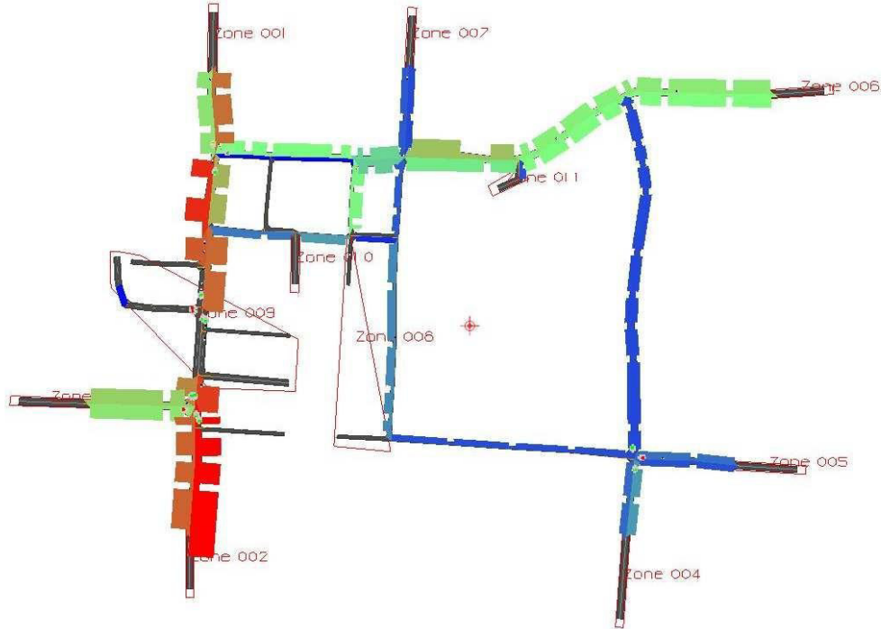
Stato di fatto SDF: Flussi veicolari (blu valore minimo, verde medio, rosso massimo)
