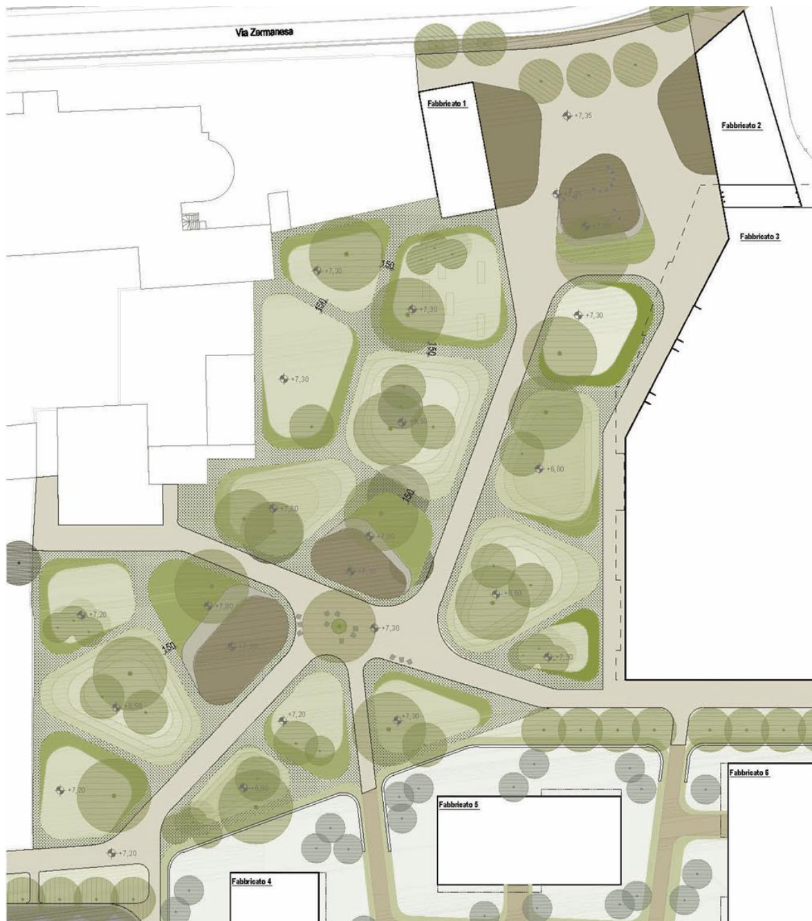
La planimetria riporta l'assetto dell'area a parco urbano con evidenziate le diverse quote delle isole verdi e la collocazione della vegetazione
